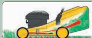
Opvangen: het afgemaaid gras wordt opgevangen in de grasopvangbak
