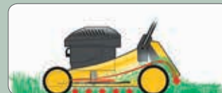
Achteruitworp: het gras wordt verspreid over de volle breedte van de machine
