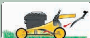
Multiclip: opvangbak verwijderen, Multiclip plug plaatsen
